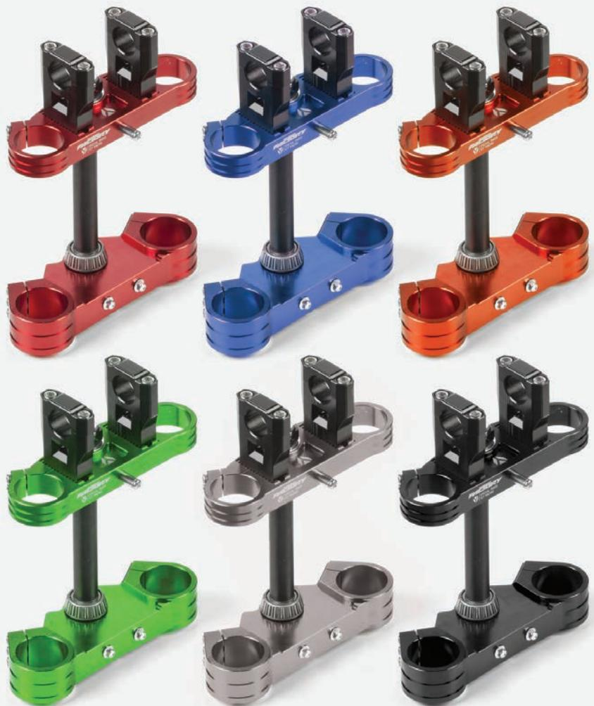
CNC GABELBRÜCKEN 3 FACH KLEMMUNG 48/45 ODER ENGI KLEMMUNG 48/48
