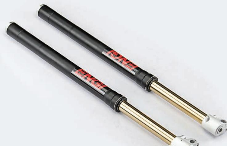
ENGI® USD FEDERGABEL MIT GOLD BESCHICHTETEN GLEITROHREN (800MM) - VOLL EINSTELLBAR
